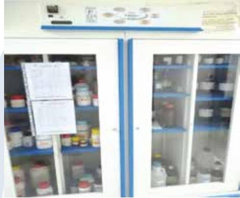
Figure 23 : Armoire à produits chimiques avec système de ventilation intégré, INH, 2017.
