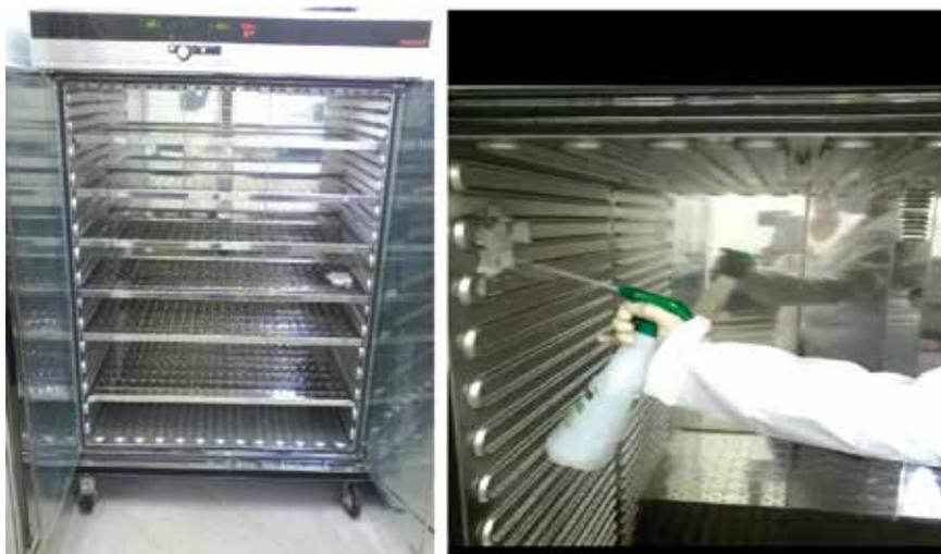
**Photo 10 : Mesures à entreprendre en cas de déversement dans l'incubateur**
