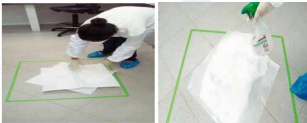
**Photo 14 : Mesures à entreprendre en cas de déversement sur le sol**
